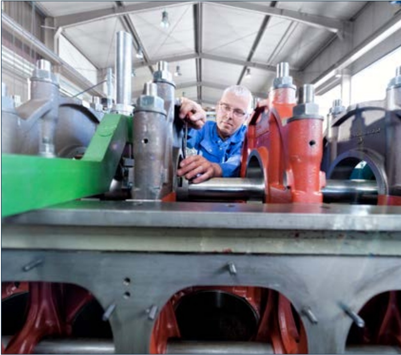
Bohren einer Grundlagergasse
